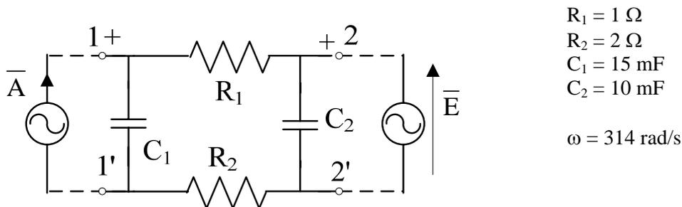
Si descriva il doppio bipolo passivo rappresentato in figura mediante i parametri [Y] e i parametri [Z], in forma cartesiana:
