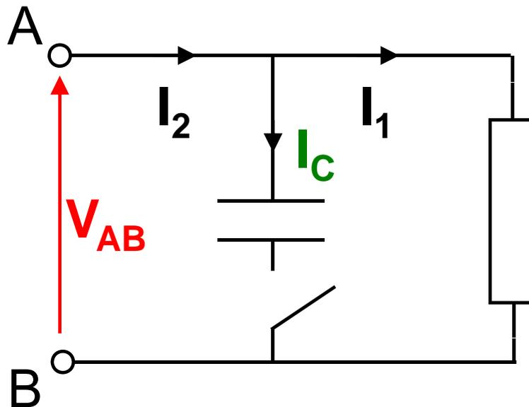
Esempio: rifasare un carico induttivo a  $\cos(\varphi)=0.8$  mediante un condensatore
