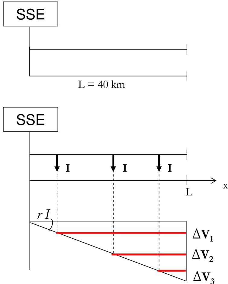
Per differenti posizioni del treno avremo, a parità di corrente assorbita, tre differenti valori di caduta di tensione funzione della resistenza della catenaria e della posizione del treno (pendenza  $rI$  della retta) .
