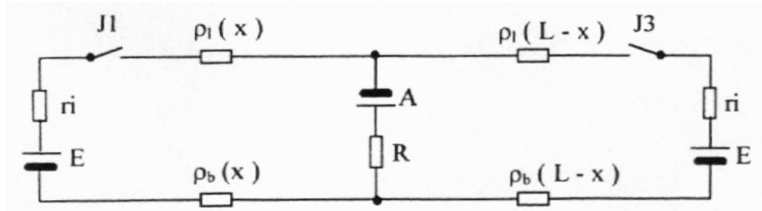
$E$  = tensione a vuoto delle SSE = 3600 V
