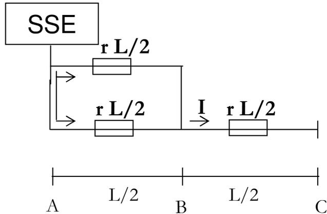
Nella maglia del circuito le due resistenze sono in parallelo quindi la resistenza equivalente =  $r L/4$
