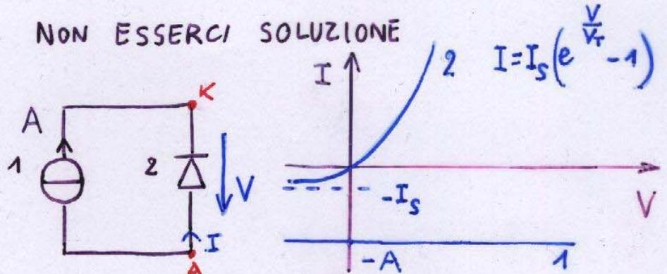
2 : DIODO A GIUNZIONE p-n REALE
