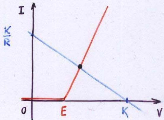
SE, IN UN CIRCUITO CON UN BIPOLO NON LINEARE, INTORNO AL PUNTO DI FUNZIONAMENTO IN REGIME STAZIONARIO  $(V_0, I_0)$  SI HANNO PICCOLE VARIAZIONI  $(\Delta V, \Delta I)$  CAUSATE DA PICCOLE  $(\Delta E, \Delta A)$  IMPRESSE, SI PUÒ APPLICARE IL
