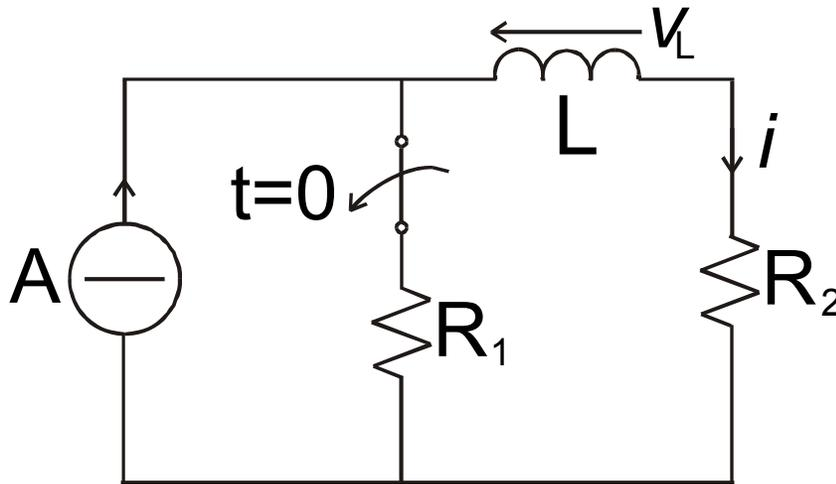
Variabile di stato  $i$        $i(0^-) = \frac{AR_1}{R_1 + R_2}$  ,  $i(0^+) = A \neq i(0^-)$
