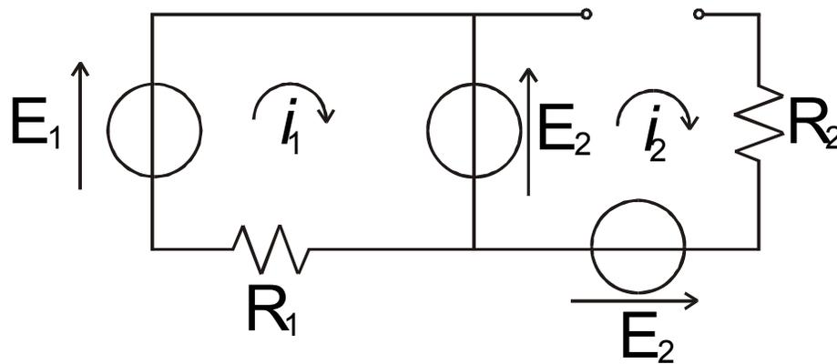
$$i_L=0 \quad , \quad v_C=E_2 \quad , \quad i_1 = \frac{E_1 - E_2}{R_1} \quad , \quad i_2=0 \quad \text{Valori iniziali}$$
